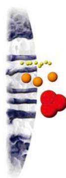
3. 缓冲液（流动相）和样品流过柱子。分子进入或不进入柱料的孔中（也被描述成样品在移动相和固定相中进行分离）。小一些的分子移动得更远进入柱料，在柱子中停留时间更长。
