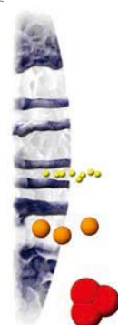
4. 当缓冲液持续流过柱子，大于柱料孔的分子不能进入孔中，流过柱子。小分子进入孔中，延时流过柱子。
